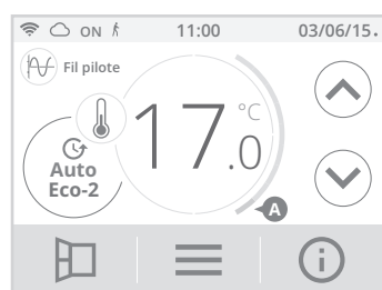
Fil pilote = Éco - 2 Confort - 2°C
