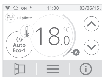
Fil pilote = Éco - 1 Confort - 1°C
